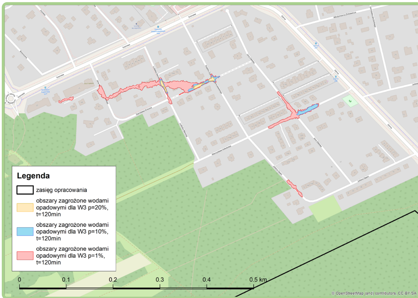
Rysunek 31 Porównanie wyników identyfikacji obszarów zagrożonych wodami opadowymi dla opadu o prawdopodobieństwie 1%, 10% i 20% i czasie trwania 120 min dla Puław część 2
