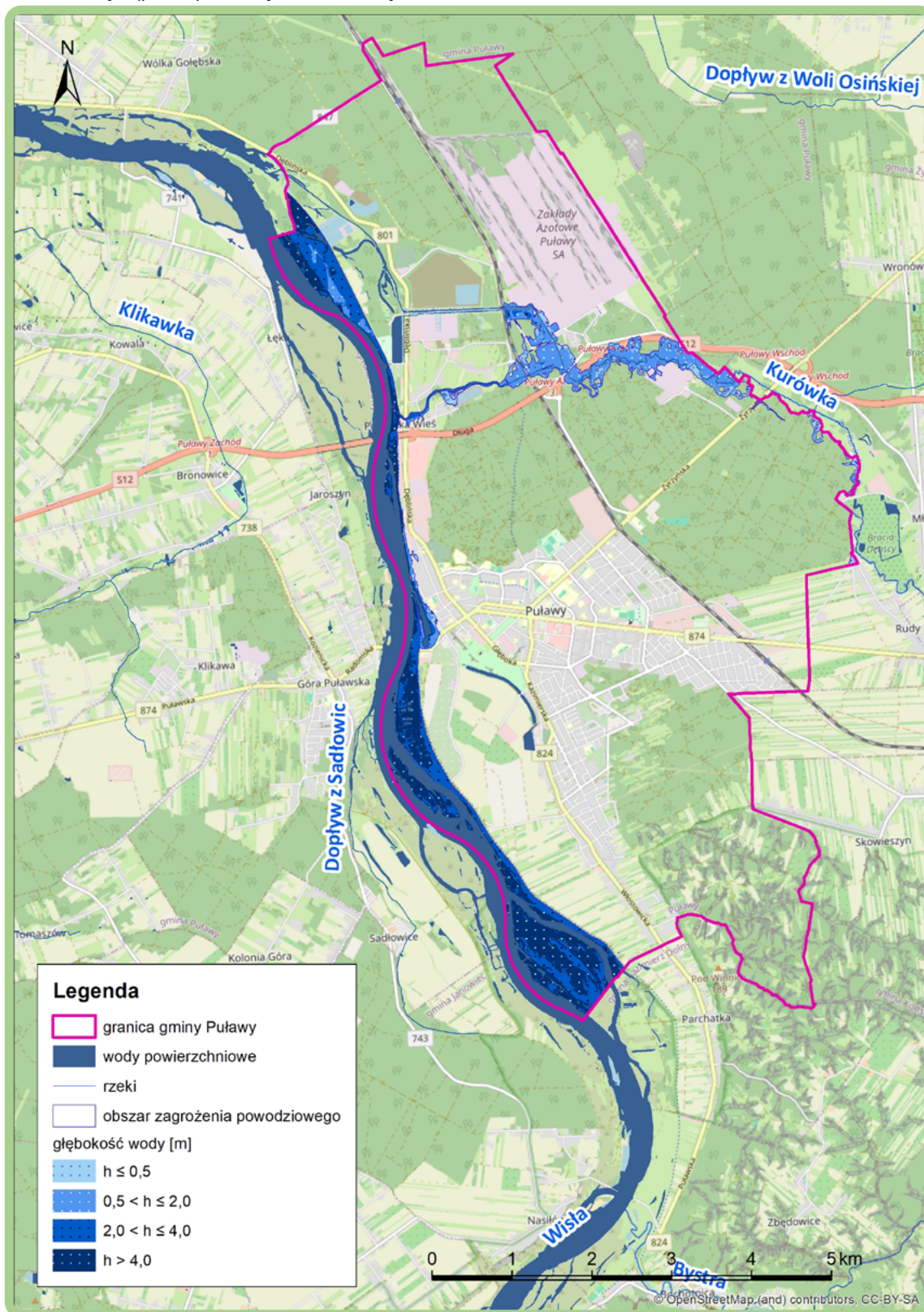
Rysunek 13 Obszar gminy miejskiej Puławy, mapa zagrożenia powodziowego z głębokością wody. Obszary, na których prawdopodobieństwo wystąpienia powodzi jest średnie i wynosi 1% (raz na 100 lat)
