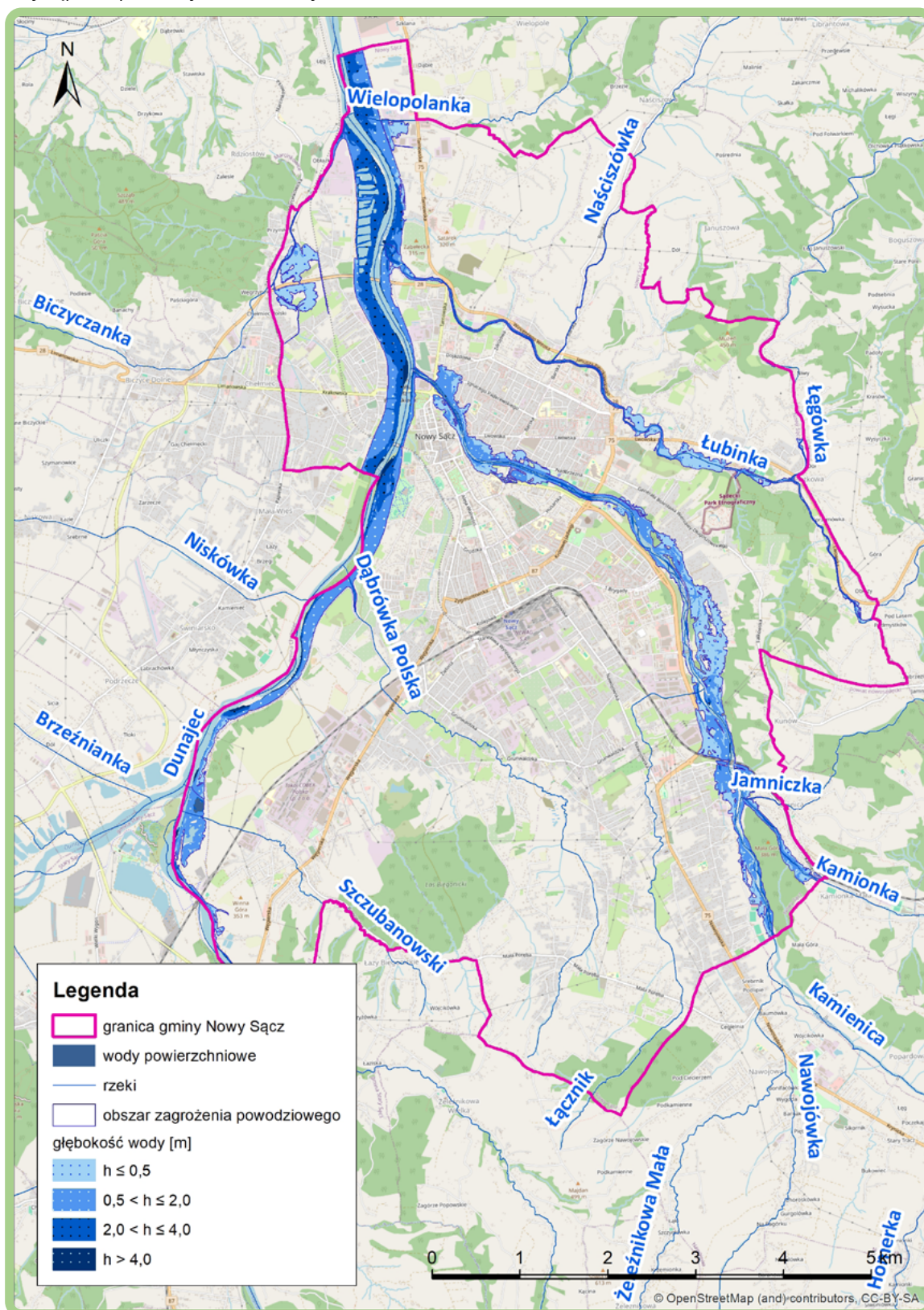
Rysunek 12 Obszar Nowego Sącza, mapa zagrożenia powodziowego z głębokością wody obszary, na których prawdopodobieństwo wystąpienia powodzi jest średnie i wynosi 1% (raz na 100 lat)
